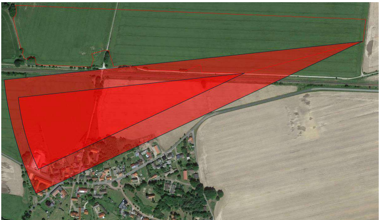
Abbildung 24: Potenzielle Reflexionen in Richtung Westen auf den Ortsteil Rockenthin für zwei Punkte des Parks
