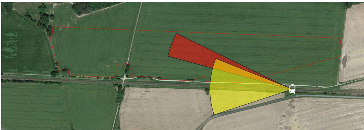
Abbildung 17: Relevanter Sichtwinkel des Zugführers auf der Bahnstrecke in Gelb, Immissionswinkel möglicher Reflexionen von der Modulfläche in Rot (Quelle: Google Earth)
