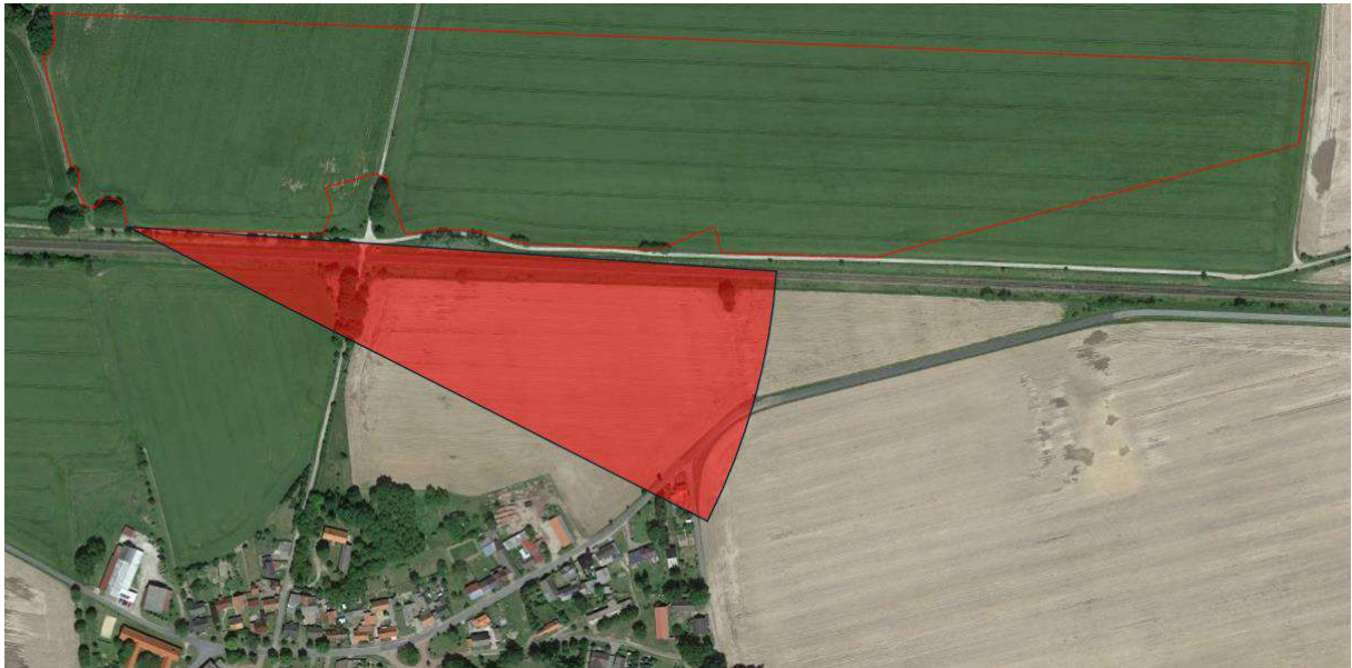
Abbildung 23: Potenzielle Reflexionen in Richtung Osten auf den Ortsteil Rockenthin
